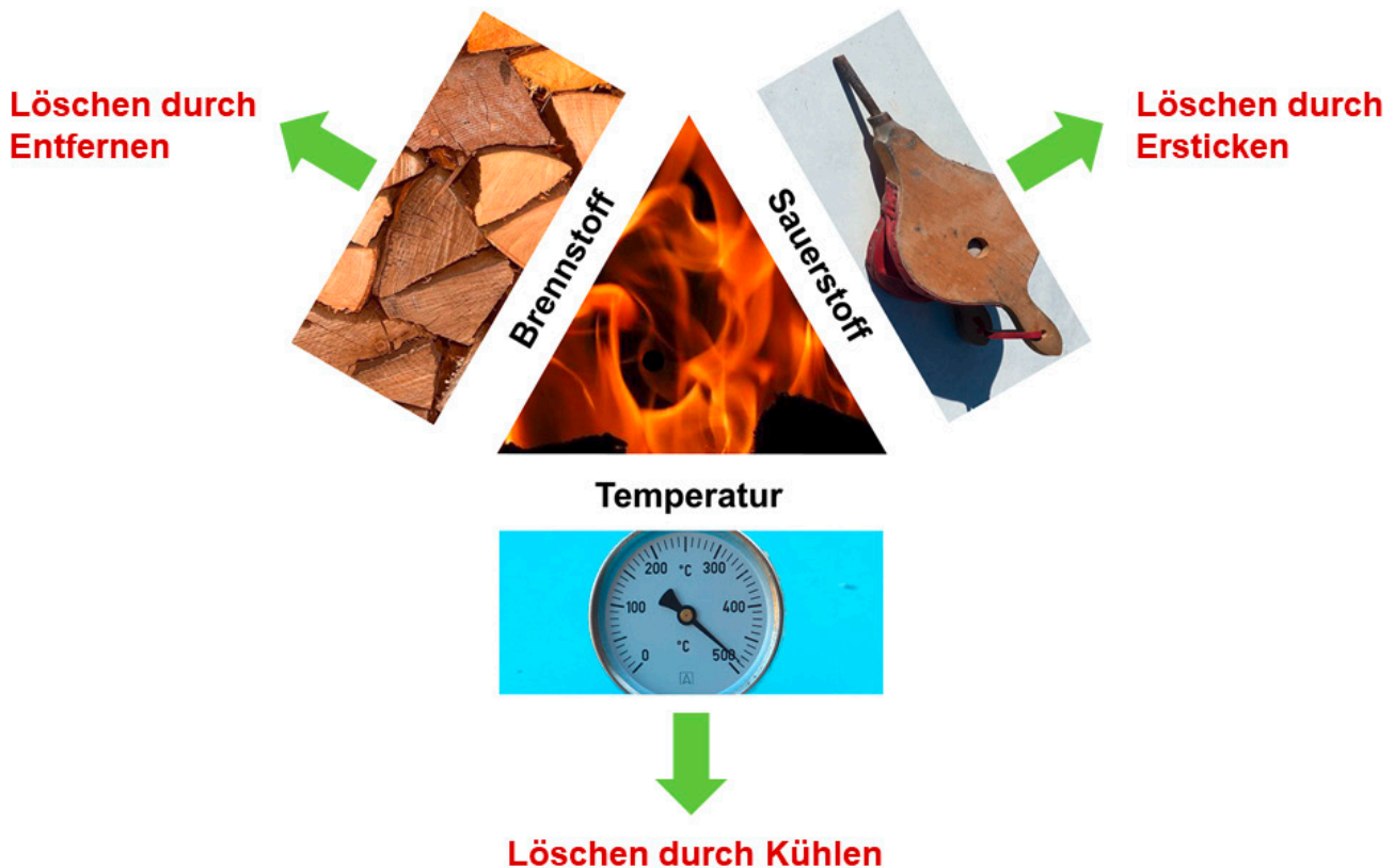
Abb. 4. Das Verbrennungsdreieck – auf diesem Grundprinzip basiert der Einsatz jeder Feuerwehr: Gelingt es, mindestens eines der drei Elemente vom Brandherd zu isolieren, kommt der Brand zum Erliegen.
