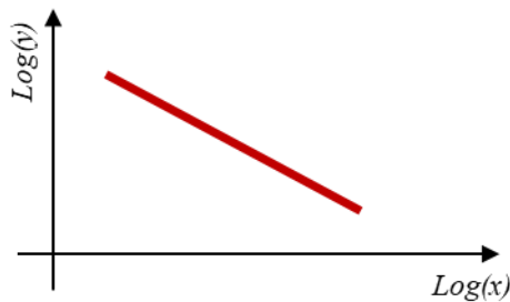
Abbildung 4-4 Wrights Gesetz: Graphische Darstellung der nichtlinearen Abnahme der Stückkosten y über die kumulierte Produktion x , ( \log(y) linear über \log(x) ).
