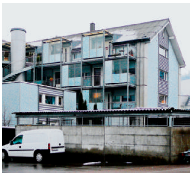
Fig. 34: mode de construction moderne – maison d'habitation (année de construction 1999) et bâtiment industriel (année de construction 1972, transformation/nouveau revêtement de façade 2002/03). L'enveloppe du bâtiment est constituée de matériaux relativement sensibles à la grêle tels que la tôle (façade, stores à lamelles, revêtements, annexes en façade), le ciment fibreux (toiture), la matière synthétique (avant-toits) et des surfaces en bois peintes (façade). Les pans du toit ne protègent pas ou à peine contre la grêle (photos: UIR).
