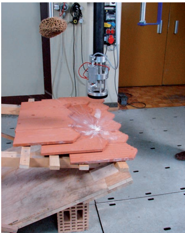
Abbildung 6.19: Hagelkanone mit aufgebauten Ziegeln, Foto Empa.
