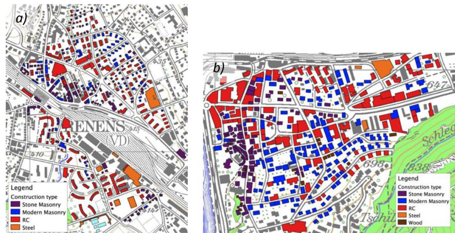
Bild 4: Verteilung der Bauweisen in a) Renens (VD) und b) Visp (VS).
