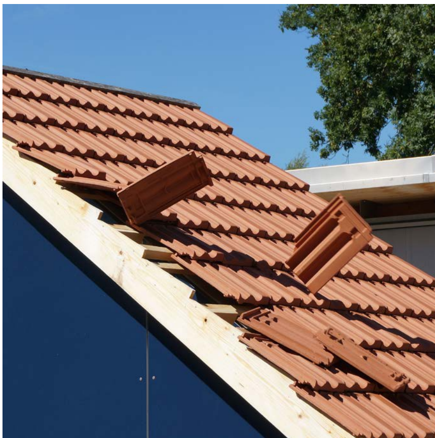
Illustration 24 : Sur le Campus Sursee, centre de formation pour les professionnels de la construction, un essai au vent a été effectué avec un ventilateur à grand débit (non visible sur la photo) soufflant depuis le côté gauche de la photo en direction du faite du toit : les tuiles de bordure qui ne sont pas assurées sur leur bord extérieur sont les premières à être soulevées, à se désolidariser de l'assemblage, et à être emportées par le vent ou à glisser le long de la pente du toit, jusqu'à chuter au sol. Dans le cas de bâtiments réels, les tuiles arrachées constituent un danger imminent pour les personnes, pour les véhicules et pour les bâtiments voisins. (source : UIR)
