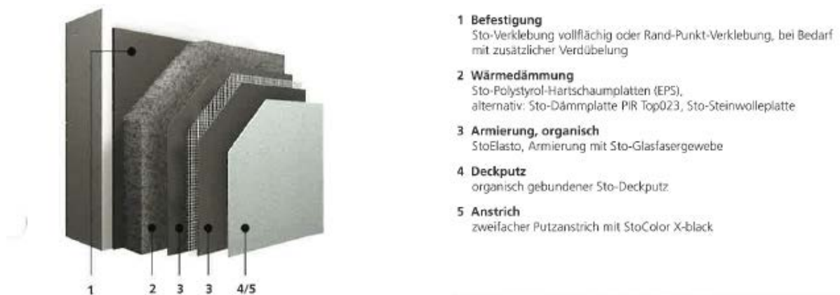
Bild 10: Innerer Aufbau eines typischen Wärmedämmverbundsystems [23]
