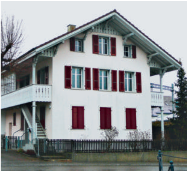
Abb. 33: Ältere Bauweise: Wohnhaus (Baujahr 1904) und Fabrikgebäude (Baujahr 1917). Die Gebäudehülle besteht v.a. aus relativ hagelresistenten Materialien wie Ziegel (Dächer), Verputz auf Mauerwerk (Fassade) und Massivholz (Fensterläden, Fassadenanbauten, Türen). Die ausladenden Dachflächen schützen die Fassaden recht wirkungsvoll vor Hagelschlag (Fotos: IRV).
