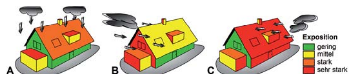
Abb. 59: Schematische Darstellung der Abhängigkeit der Schadenwirkung vom Einschlagswinkel der Hagelkörner. Fall A: Ohne Wind fallen die Hagelkörner nahezu senkrecht. Fall B: Getrieben durch starken Wind treffen die Hagelkörner in sehr flachem Winkel auf die Dachfläche mit parallel zur Windrichtung verlaufendem First. Fall C: Getrieben durch starken Wind treffen die Hagelkörner in steilem Winkel auf die Dachfläche mit quer zur Windrichtung verlaufendem First. Rechtwinklig zur Einschlagsrichtung verlaufende Bauelemente sind dem Hagel stark bis sehr stark ausgesetzt, parallel dazu verlaufende Bauelemente sind hingegen nur mässig bis geringfügig ausgesetzt, je nachdem, ob sie noch durch ein Vordach geschützt sind oder nicht.
