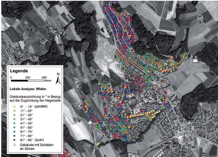
Abb. 53: Orthofoto von Widen; rote Ringe bezeichnen Gebäude mit Schäden an Storen, die farbigen Punkte bezeichnen die Firstorientierung bezüglich der Hagelzugrichtung (vgl. Legende). (Aufnahme: swisstopo.)
